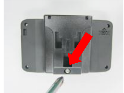
po wsunięciu zabezpiecz uchwyt dokręcając śrubę
